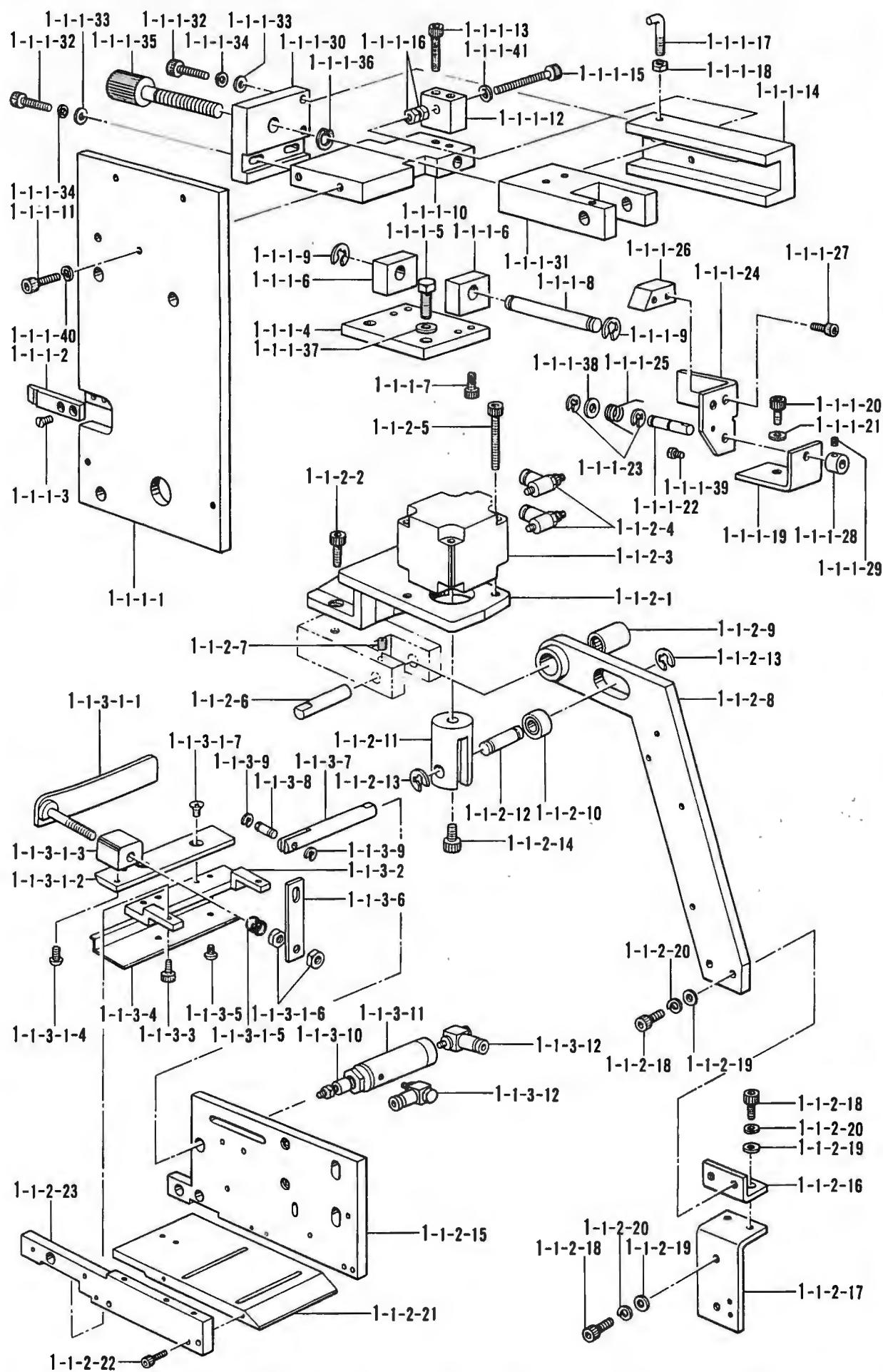
Q. フィーダユニット関係/Feeder unite mechanism/Transport-Kupplung/
