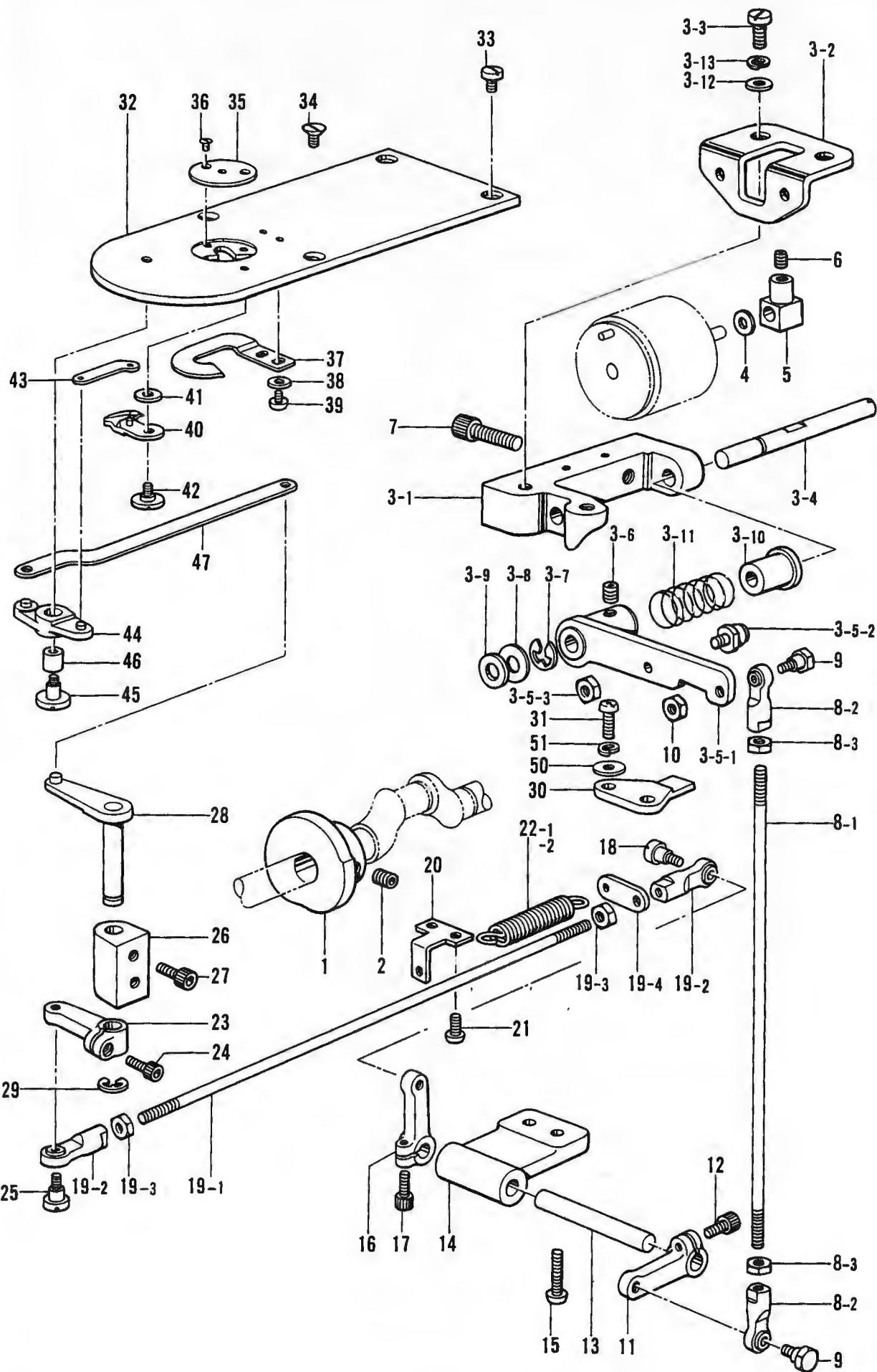
J. 糸切り関係 / Thread trimmer mechanism / Fadenabschneidevorrichtung /
