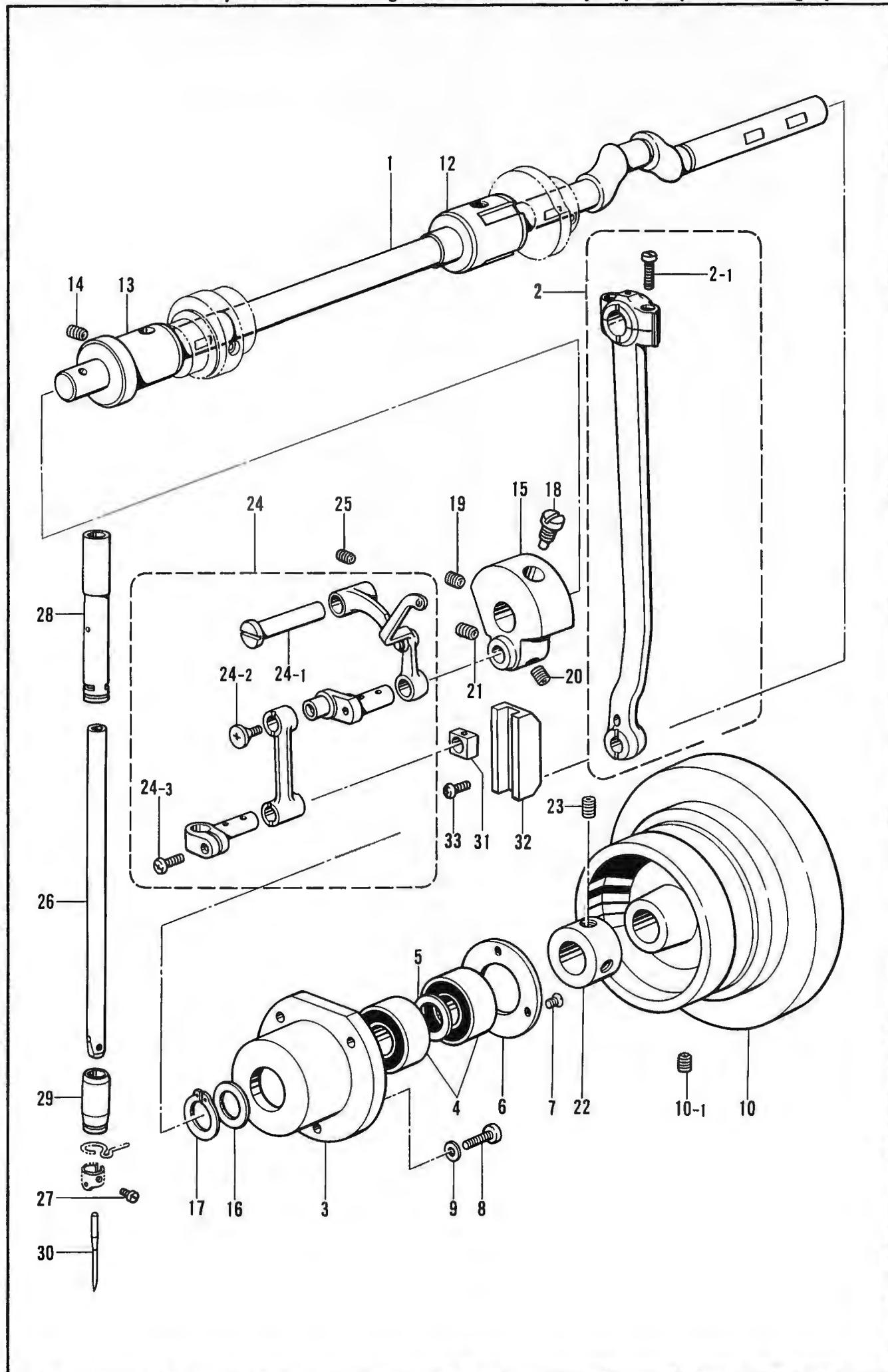
B. 上軸針棒関係/Upper shaft and needle bar mechanism/Obere Welle und Nadelstangenvorrichtung/
