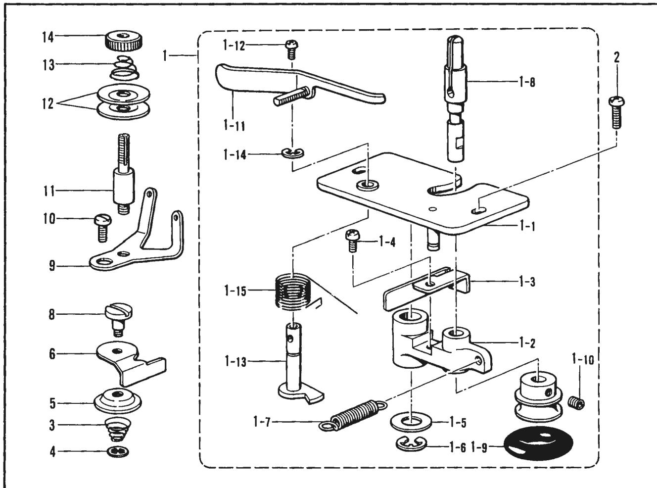
L. ワイパー関係/Thread wiper mechanism/Fadenwischvorrichtung/
