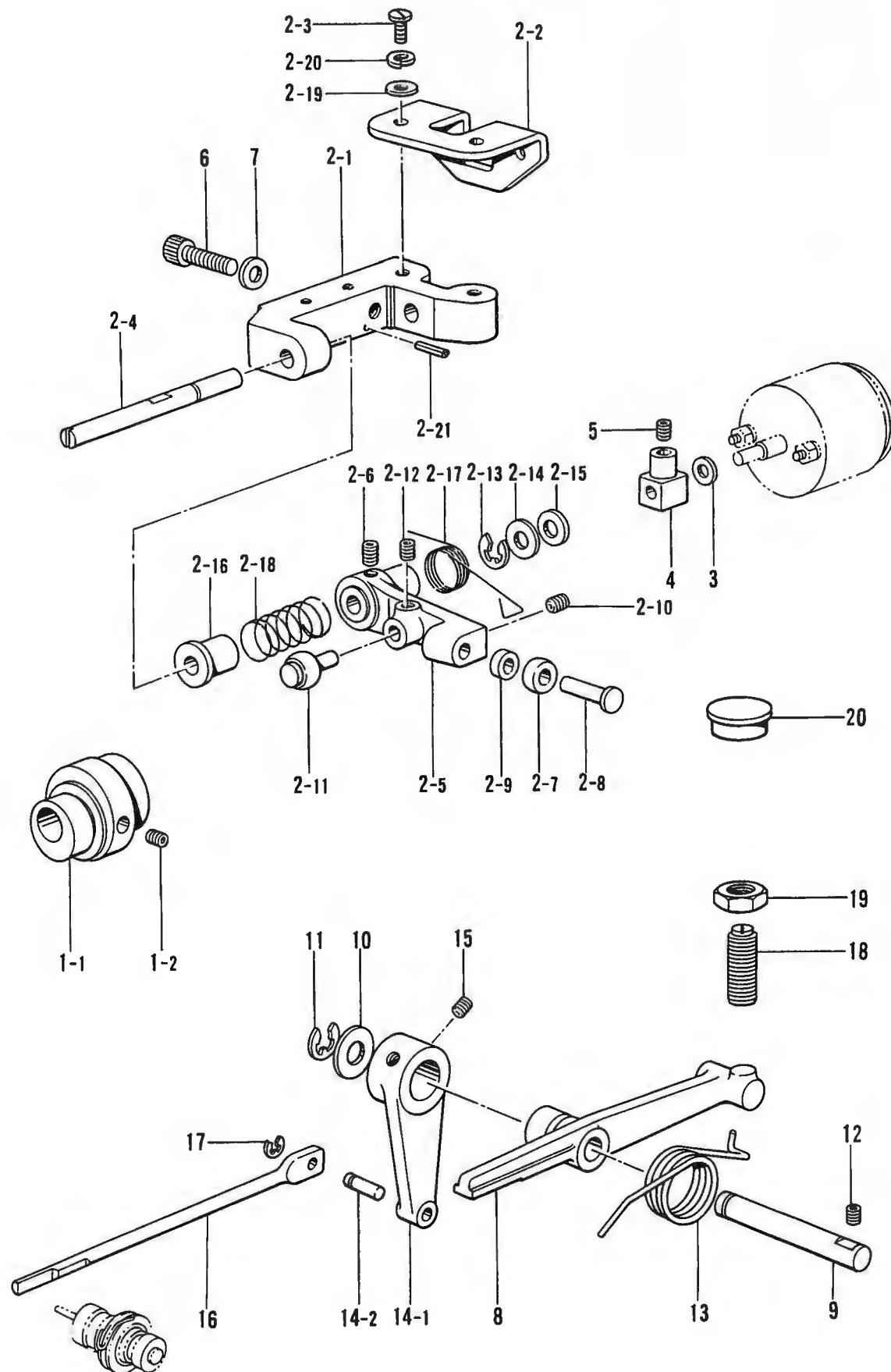
D. 押工上ヶ関係 / Work clamp lifter mechanism / Stoffhalterhebervorrichtung /
