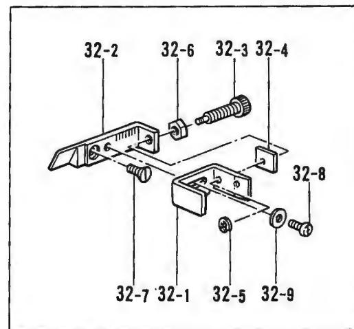
H. 糸通シ関係 / Threading mechanism / Fadenführungs vorrichtung /
