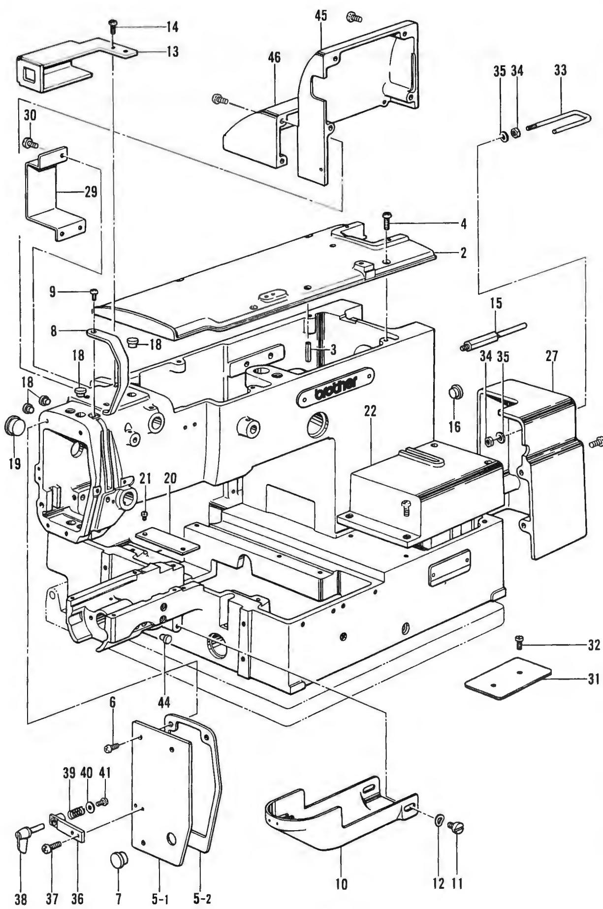
A1. 主体関係/Machine body/Maschinengehäuse/
