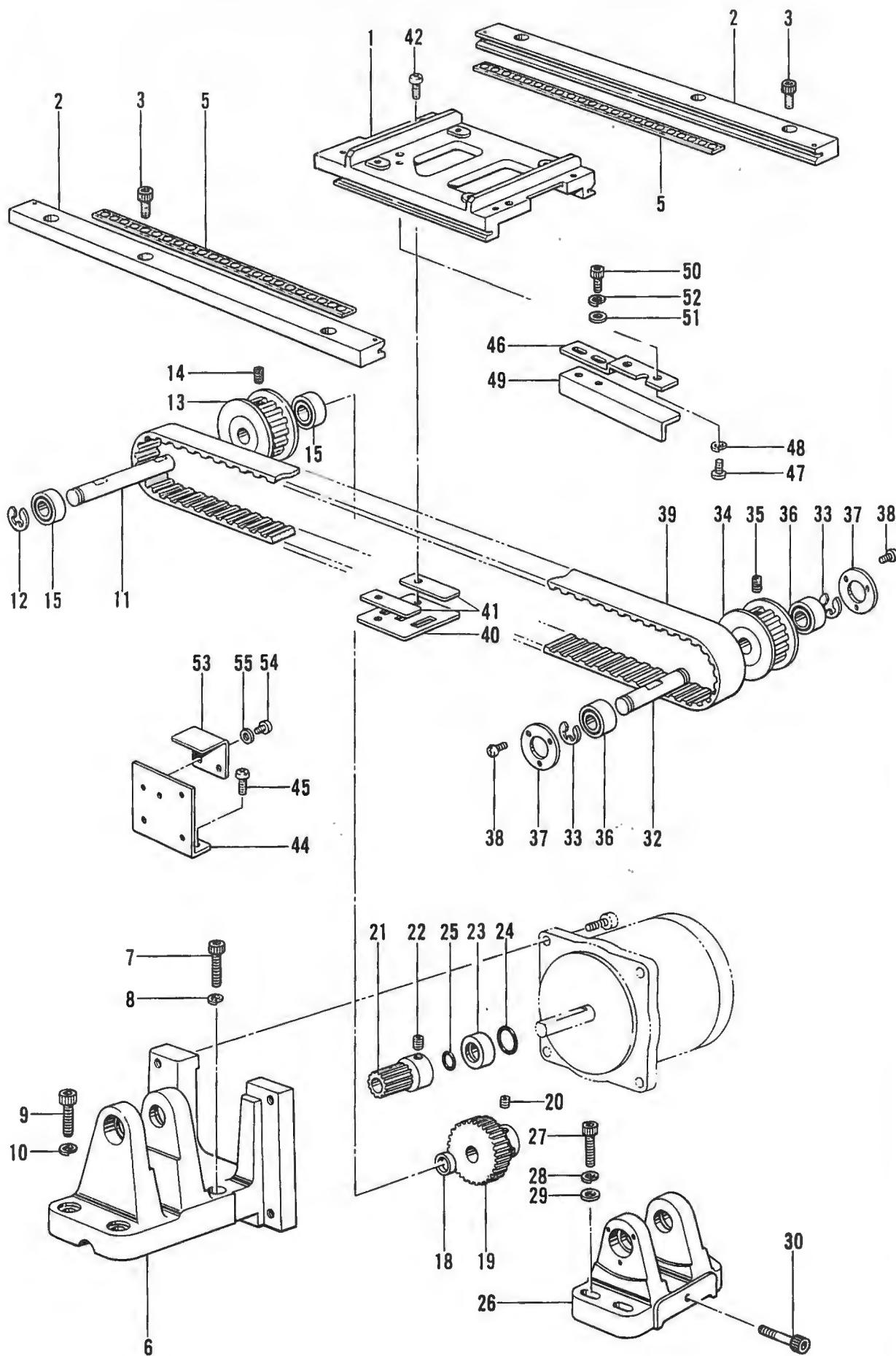
E. 駆動側・送り関係 / Feed guide mechanism / Transportführung /
