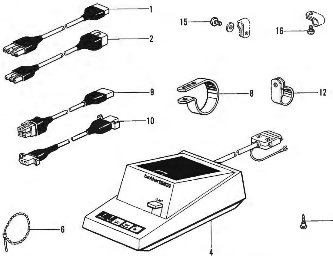
R. コントロールボックス関係 / Control box mechanism / Schaltkasten /
